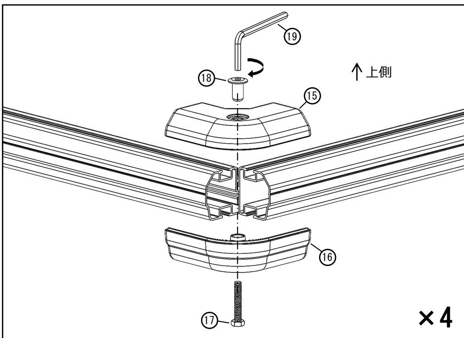
1 ルーフキャリアを再度ひっくり返し、前後枠フレーム②・サイドフレーム①を挟み、コーナーエルボ(A)⑯・コーナーエルボ(B)⑰を上下から被せます。ボルトとコネクターナットで固定します。
