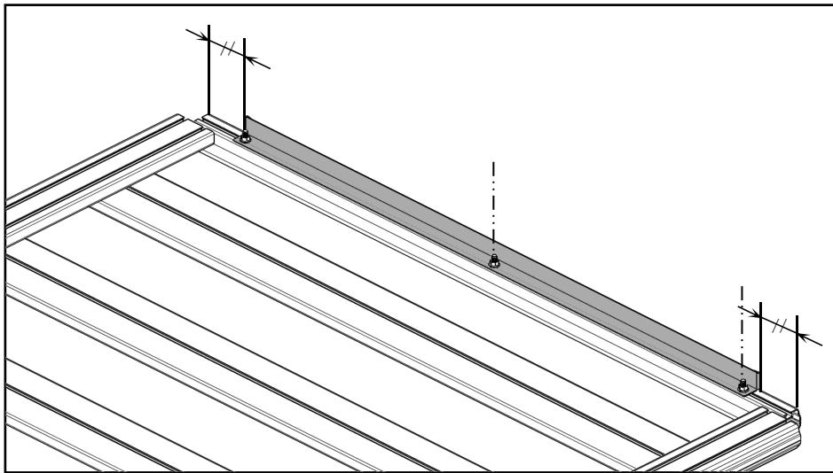
3 左図のように前後枠フレーム端部までの距離が左右均等になるよう、風切音防止板⑦の位置を調整し、ナットを締込みます。
