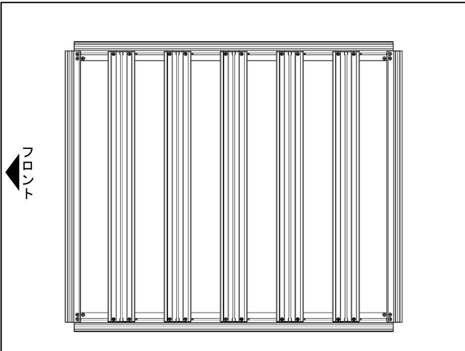
2 床板③をサイドフレーム①の上に置き、スロットの中に入れてある床板固定プレート④と一緒にボルトで仮止めします。
