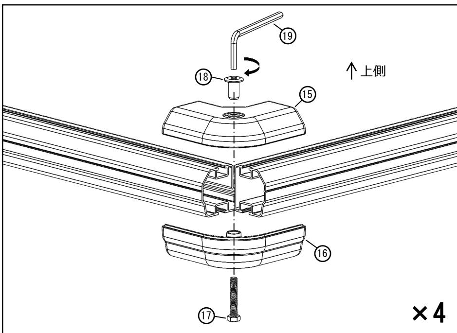
1 ルーフキャリアを再度ひっくり返し、前後枠フレーム②・サイドフレーム①を挟み、コナーエルボ(A)⑯・コナーエルボ(B)⑰を上下から被せます。ボルトとコネクターナットで固定します。
