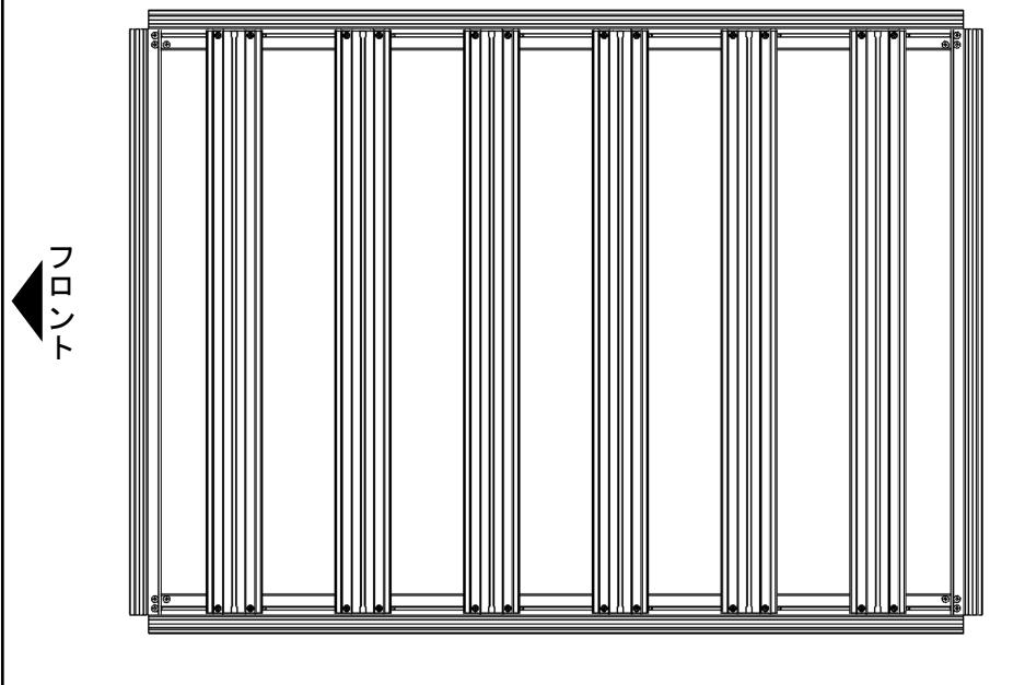
2 床板③をサイドフレーム①の上に置き、スロットの中に入れてある床板固定プレート④と一緒にボルトで仮止めします。
