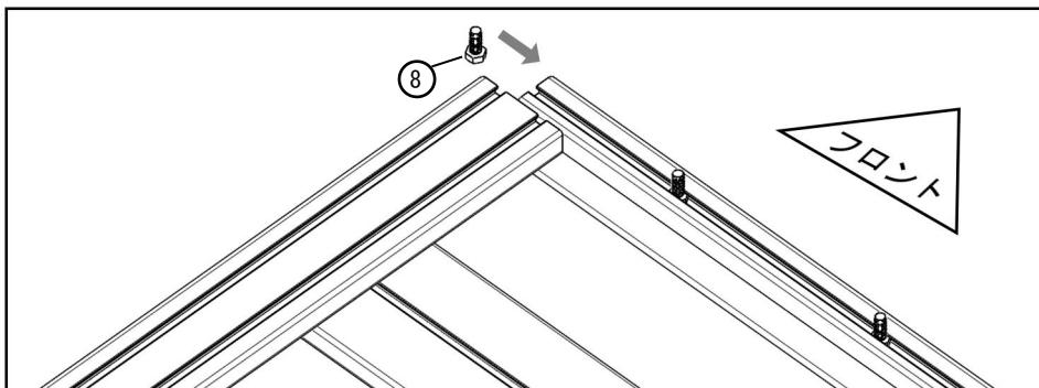
1 前側の前後枠フレーム②のスロットにボルトを入れます。
