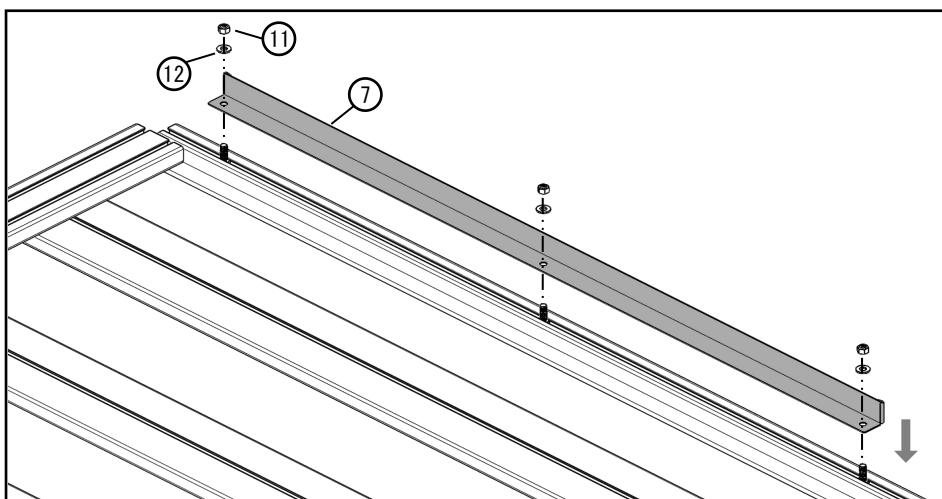
2 入れてあるボルトの位置を調整し、左図のように風切音防止板⑦を仮止めします。
