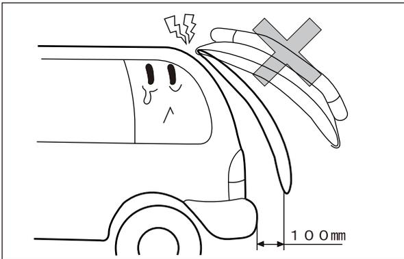
リアラダーのアンダーフックをかける際、リアゲートを必要以上開けますと、アッパーフックが外れ、車両が破損するおそれがあります。リアラダーのアンダーフックをかける際はリアゲートを100mm以上開けないでください。
