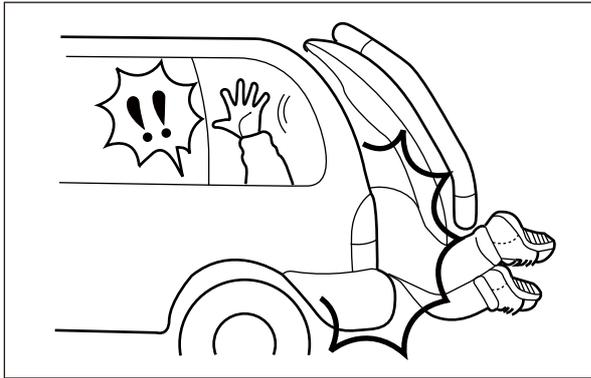
リアラダーを車両に取付けた状態でのリアゲートの開閉には十分な注意をしてください。リアゲートが急激に閉じて人がはさまれるなどの重大な事故が起きるおそれがあります。
