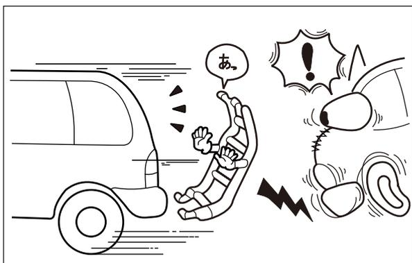
リアラダーをゆがんだ状態で車両に取付けますと、走行時の風圧・振動によりリアラダーが脱落し、後続車や人を事故に巻き込むおそれがあります。リアラダーは、本取扱説明書の『車両への取付』の内容をよく理解、ご注意いただき、取付位置を厳守し、車両に対して傾かないように取付けてください。
