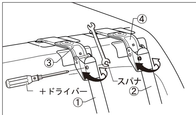
(1) リヤラダー本体が、取付位置からずれないように注意し、アッパーフック Assy(L)(R) ③④の先端部の角度を、リアゲート端部に合わせ、仮止めしてある、ブラケットとアッパーフック Assy ③④を完全に固定します。
