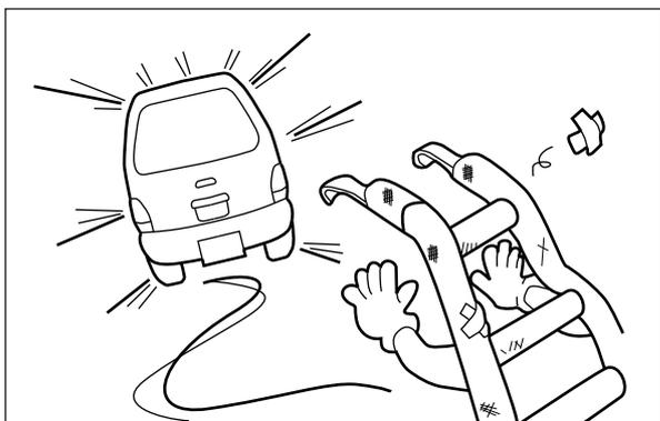
法定速度を超えた連続高速走行、悪路走行をしますと、各締付け部のボルト類のユルミが発生し、リアラダーが脱落し、後続車や人を事故に巻き込むおそれがあります。法定速度を守り、悪路では速度を落としてください。
