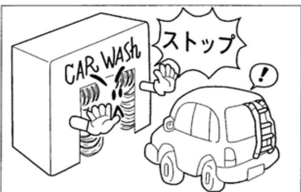
リアラダーを装着したまま自動洗車機を使用すると、リアラダーが脱落し、車両を破損させることがありますので自動洗車機による洗車はできません。リアラダーを外すか、手洗いをしてください。
