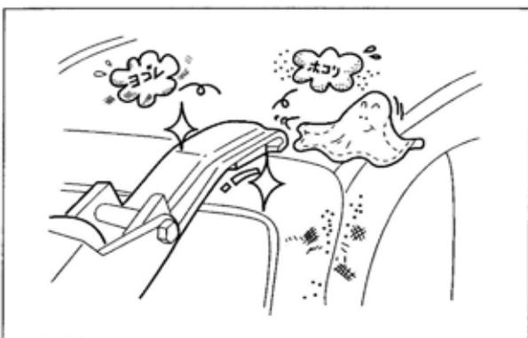
リアラダーを取付ける際、取付部に砂・ホコリ等が付着していると、車両を傷つけるおそれがあります。リアラダーの取付けは、取付部の汚れをきれいに落としてからにしてください。
