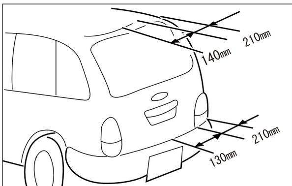
リアラダーを取付指定位置以外に取付けると、固定力不足によりリアラダーが脱落し、後続車や人を事故に巻き込むおそれがあります。リアラダーは、必ず取付指定位置に取付けてください。
