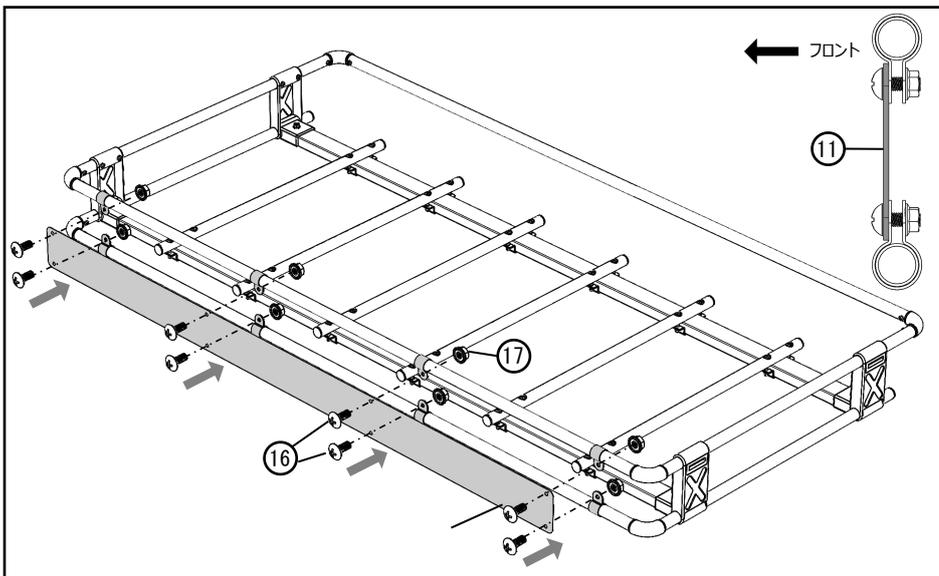
**1** 記名板<sup>11</sup>をバンド<sup>6</sup>に M6 x 15 トラスネジ<sup>16</sup>と M6 セレイト付フランジナット<sup>17</sup>で仮止めします。
