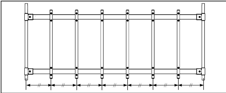
**2** 「中間 ASSY」を均等に配置し、仮止めしてある M5 x 35 丸皿ネジ<sup>15</sup>を締めます。
