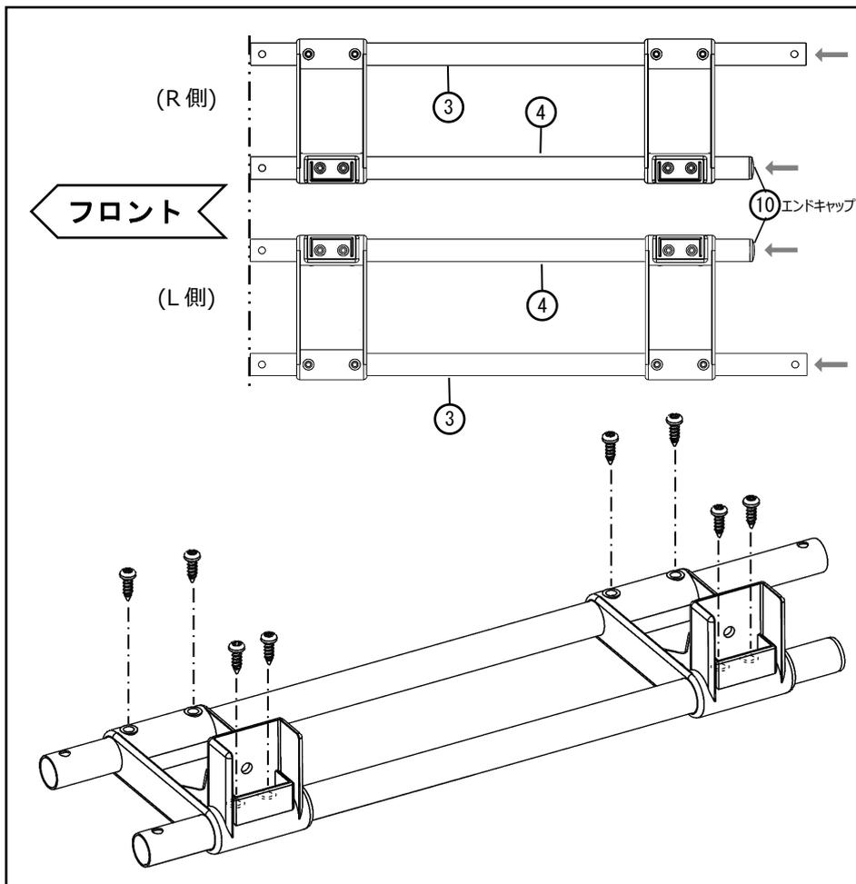
**2** 左図のように前端揃えで横枠ステー⑧に横枠パイプ(上)③・横枠パイプ(下)④を差込み、M5×16 ナベ小タッピングネジ⑬で固定します。横枠パイプ(下)④の後端からエンドキャップ⑩を打込みます。
