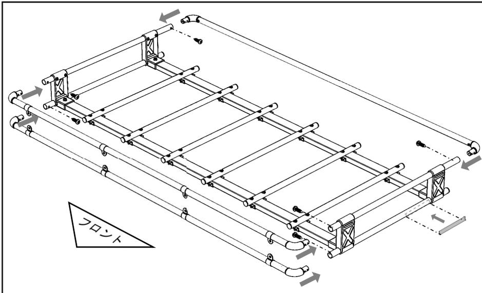
**1** 左図のように「横枠 ASSY」に「前枠 ASSY」・「後枠 ASSY」を差込み、M5 x 16 ナベ小タッピングネジ<sup>13</sup>で固定します。左側の横枠パイプ(下)④に重量ラベル<sup>12</sup>を貼付けます。
