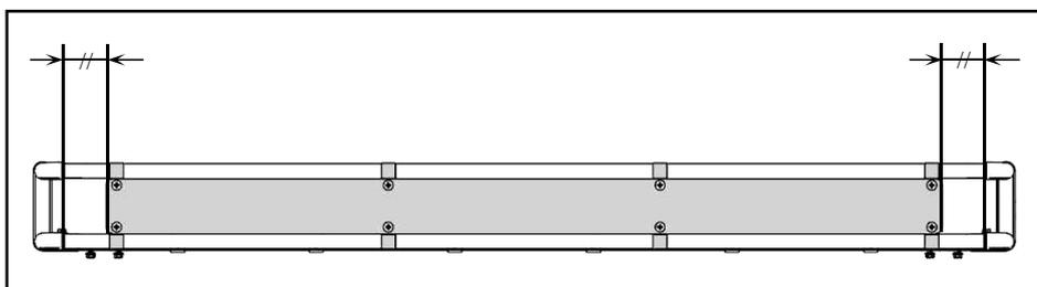
**2** 左図のように左右の隙間を均等にすべく、記名板<sup>11</sup>の位置を調整し、M6 x 15 トラスネジ<sup>16</sup>・M6 セレイト付フランジナット<sup>17</sup>を締めます。
