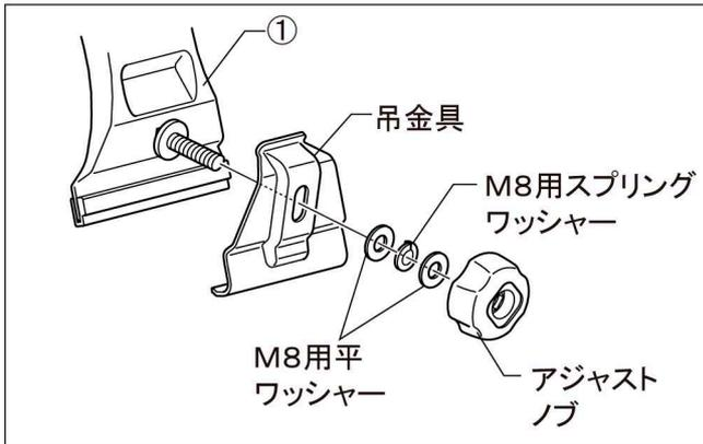
(1)脚 Assy ①からアジャストノブ、M8用平ワッシャー、M8用スプリングワッシャー、吊金具をそれぞれ外します。
