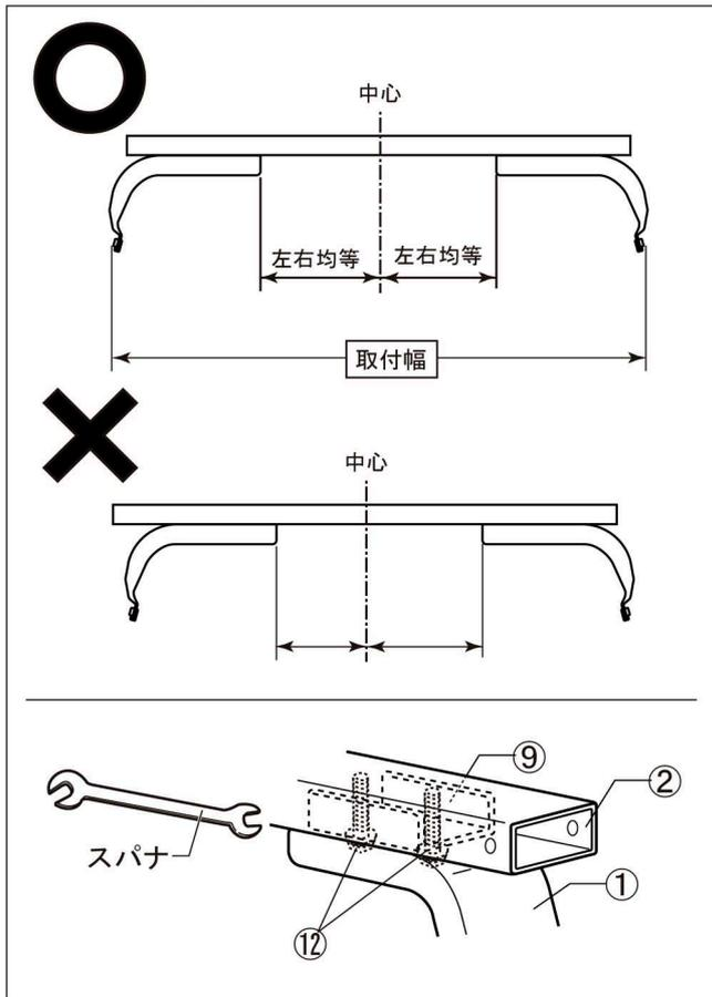
(1)「2. 脚取付幅の測定」の作業で測定した脚取付幅が、左右均等に取付けられているか確認します。均等でない場合は、M6×20セムスボルト⑫を緩め、脚 Assy ①の位置を調整してください。
