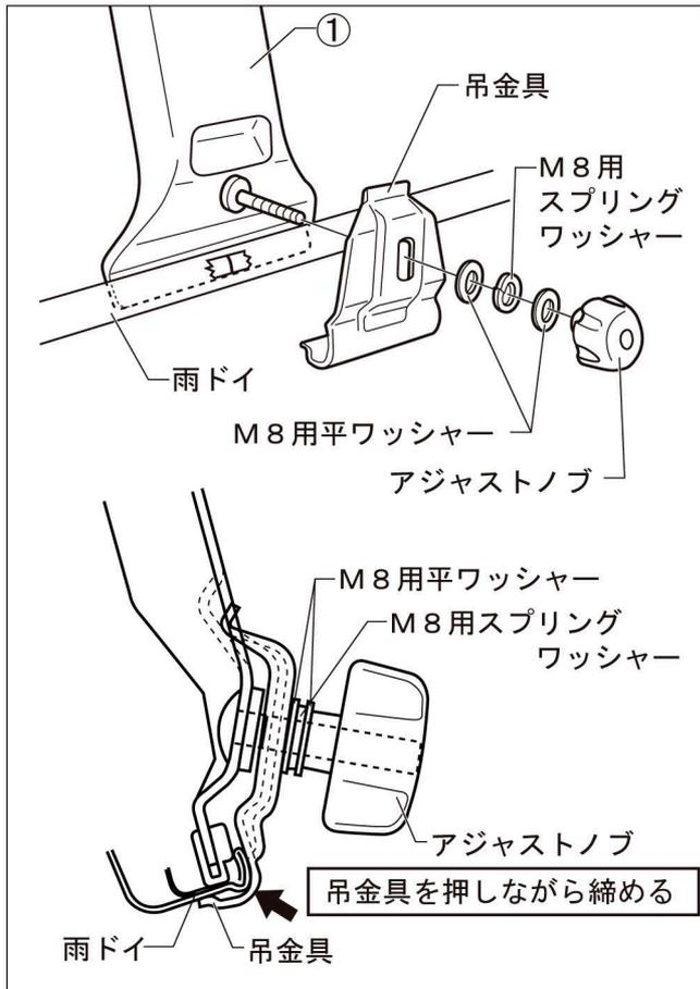
(1)脚取付位置用マーキング位置の雨ドイに脚下部の中心を合わせて差し込みます。
