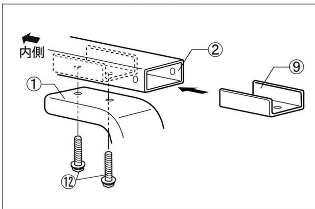
(1)フレーム角パイプ②にスライド金具⑨の向きに注意して差し込み、脚 Assy ①を M 6×20 セムスボルト⑫で仮組みします。(20ヶ所)
