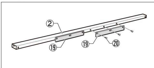
(1)フレーム角パイプ②(フロント用)の側面部に左図の要領でフラップ①⑨2個をM5×12トラスネジ②⑩で取付けます。
