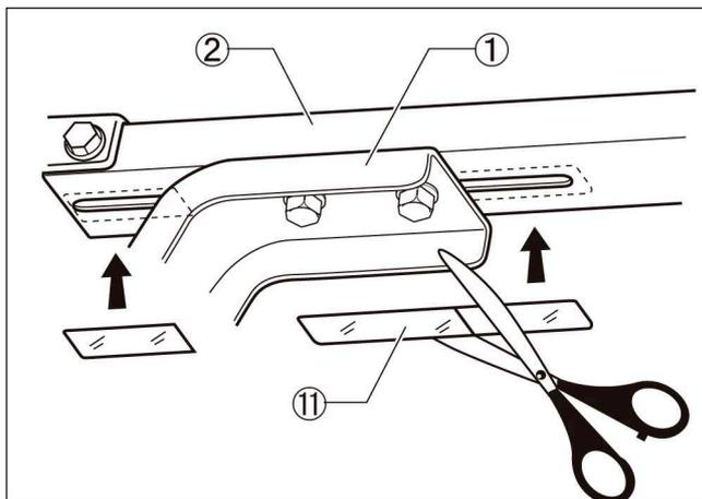
(1)脚 Assy ①を固定しているフレーム角パイプ②の長穴部を、フレームパッド⑪で塞ぎます。フレームパッド⑪は、左図のように隙間の長さより10mm程度長めにカットして貼付けます。(20ヶ所)
