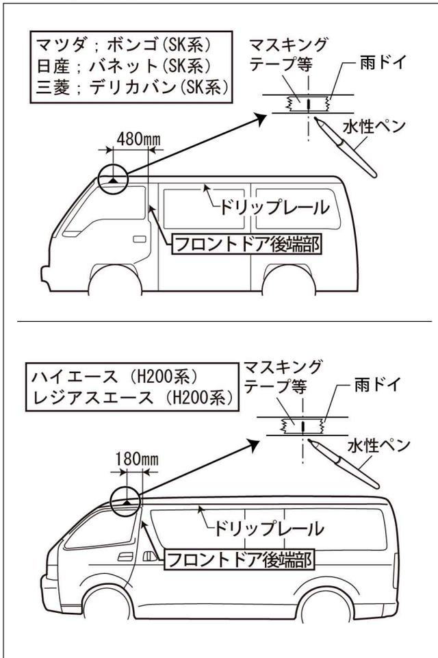
(1)フロントドア後端部を基準に、左図で示した位置を測定し、水性ペンでマーキングします。この位置が最前脚の取付位置となります。
