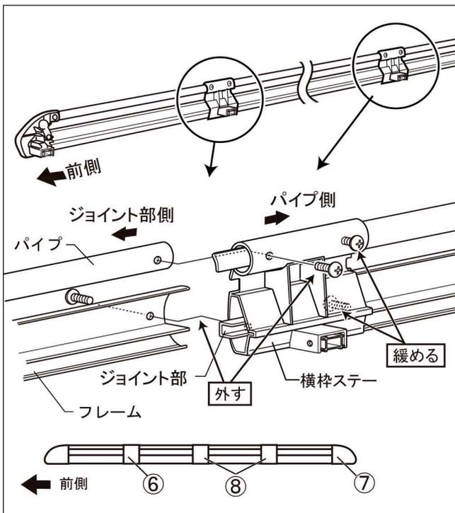
(1)横枠 Assy ⑥⑧の横枠ステーのパイプ側のビス (内側上部、及び外側下部)を緩めます。
