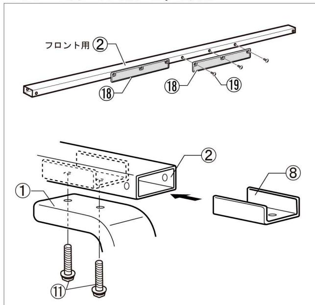
(1)フレーム角パイプ②(フロント用)側面部に左図の要領でフラップ⑯2個をM5×12トラスネジ⑰で取付けます。
