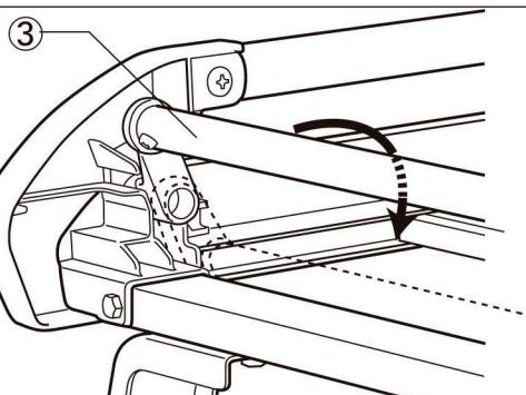
(1) 積載物に応じて、前後枠パイプの位置を変えてください。
