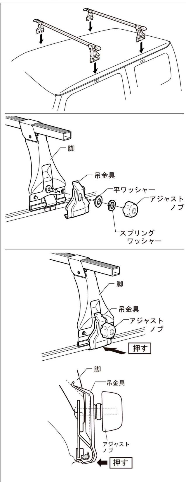
(1)組立てたキャリアをルーフのドリップレールに載せ、脚下部の中心が、マーキング位置にくるように調整します。
