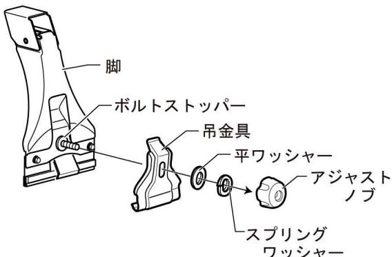
(1)脚からアジャストノブ、スプリングワッシャー、平ワッシャー、吊金具を外します。
