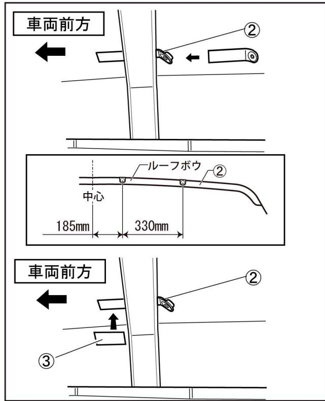
(1)1. の作業で緩めた ルーフボウとの隙間に上部取付ベルト (A) ②を図の数値の位置に仮固定します。(4ヶ所)
